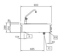
FΙ Electrical inlet (power) Equipotential screw EQ Water inlet
